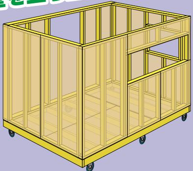
壁についても、基本通り $2 \times 4$ 材で壁枠を作つてプラットフォームに立ち上げ、枠に構造用合板を張つていった。これぐらいのサイズの小屋は、ツーバイ構法の基本をマスターするにはピッタリなのだ！
