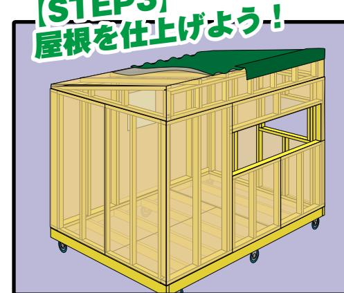
3畳タイプの小屋だと、やっぱり屋根はシンプルな「片流れ」が一番作りやすい。今回は作業を単純化するために、妻壁や前面の小壁の枠を最初に作って、その上に垂木を乗せる作戦にしてみた
