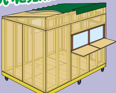
窓やドアなどの建具は、 $2 \times 4$ 材で枠を作って $1 \times 4$ 材を面材として張り付けていくのが簡単。建具作りのコツは、縦横枠の直角をしっかり出すこと。さらに、建具を収める壁枠とのクリアランスを縦横ともに5mmほど確保すれば、開閉はズムーズだ!
