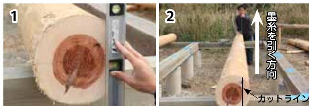
丸太を平面カットするためには、正確な墨付けが大切だ。ポイントは、丸太の側面に墨を打つときに、必ずカットする方向の延長線上に墨糸を引っ張ること。これが斜めになってしまうと大きな誤差ができてしまう。①まずは、木口にカットラインを引く。水平器を使って正確に墨付けしよう。②カット方向の延長線上に墨糸を引っ張る。木口の垂線に水平器を当てて、それを基準に墨糸を引いていくと、より正確な墨打ちができる
