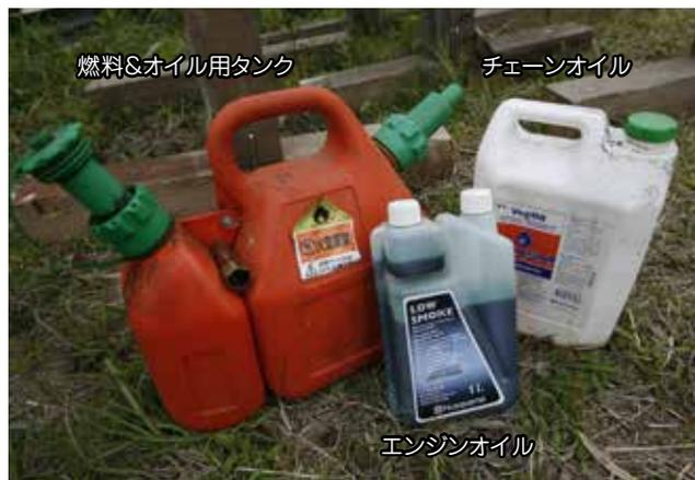
チェーンソーの燃料には、ガソリンとエンジンオイルを適正な比率で混ぜた「混合ガソリン」を使う。以前は25：1の比率が一般的だったが、現在では50：1以上のタイプが普及している。なお、ガソリンは古くなると成分が変化してしまうので、作り置きしないでつねに新鮮な燃料を使うように心掛けよう。チェーンやスプロケットなどの潤滑油になるのが「チェーンオイル」。これがなくなると、駆動系の故障につながるの、燃料を給油するときには、かならずチェーンオイルも満タンにしておこう
