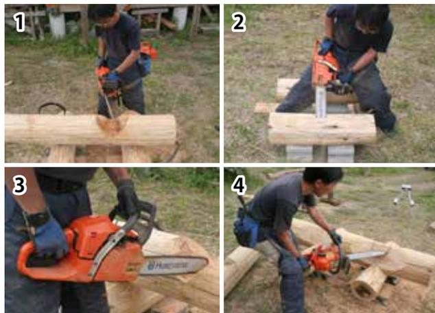
①チェーンソーを使うときは、スタンスを前後に軽く開き、リラックスした状態でチェーンソーを腰の位置で構えるのが基本。このため、カットする材料を腰～膝上の位置に置く高さのウマ（作業台）を使うのが理想だ。②状況次第では腰を落したり、しゃがむなどして臨機応変に対応したい。③左手は前ハンドルを握り、万一のキックバックに備える。後ろハンドルを握る右手は人差し指でスロットルをコントロールする。④どんな切り方でも、チェーンソーの重量を身体に分散させる気持ちで操作すると、長時間の作業でも疲れにくい。写真の場合は、右腕をヒザの上に預けてチェーンソーの重さを分散している
