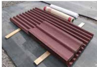
屋根の仕上げには、オンデュリン・クラシックシートを使用。材質はイーザーラインと同様だが、長さが2mあるので作業効率が格段によくなる
