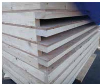
パネル方式では一枚一枚のパネルごとに作製していくので、作業は非常に効率的だ。反面、パネルの精度も要求されるため、ツーバイ材のカットや接合は、つねに正確に行うことを意識したい
