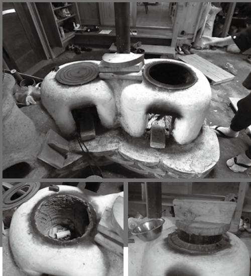
カマドの上面には、リング状の「釜つば」を設置すると便利。煙突は新ストープ用を流用すればOKだ。なお、カマドは濡れに弱いので、屋外に設置する場合は上に小屋根をかけるように
