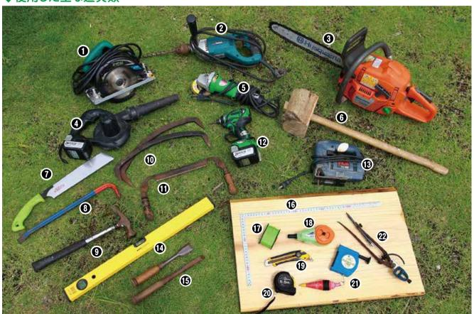
●丸ノコ。 ②電気ドリル。 ③チェーンソー。 ④ブロアー。 ⑤ディスクサンダー。 ⑥カケヤ。 ⑦ノコギリ。 ③バール。 ⑨ハンマー。 ⑩ログドッグ(かすがい)。 ⑪ピーリングナイフ。 ⑫インパクトドライバー。 ⑥ジグソー。 ⑫水平器(バーレベル)。 ⑩ノミ(10m幅、30m幅)。 ⑯サシガネ。 ⑰水糸。 ⑰ チョークライン(または墨ツボ)。 ⑲カッターナイフ。 ⑳メジャー。 ㉑下げ振り。 ㉑スクライバー。 以上が主に使用した道具類だが、このほかに作業台となるウマ、高所作業用の脚立、コンクリートを作る道具、スコップ、タッカー、エアネイラー、 塗装やコーキング用の道具なども用意。 さらに、 腰袋には鉛筆や油性ペン、ミニ定規、 手袋なども常備した。 いきなりすべてをそろえる必要はなく、ホームセンターのレンタルを利用するのも方法だ
