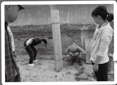
三角柱の下端に軽く丸めた新聞紙を突っ込み、ライターで着火する。安全のため、消火器を用意しておくこと安心!
